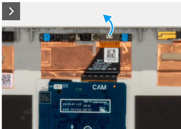
Obrázok 55. Demontáž modulu kamery
